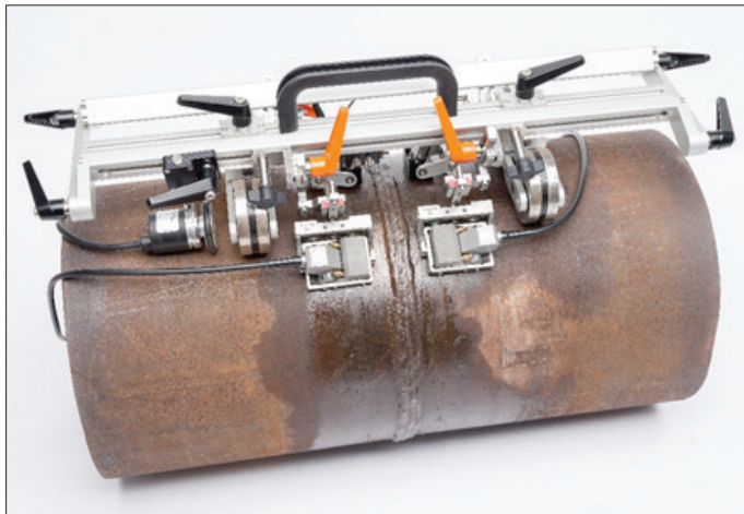
鋼管對接焊縫及環焊縫的手動掃查器，帶編碼器，磁化吸盤，探頭架帶兩個相控陣探頭和TOFD
